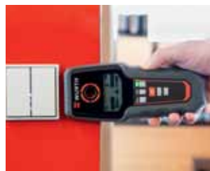
Εντοπισμός ηλεκτροφόρων αγωγών και αγωγών που δεν φέρουν τάση
