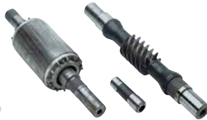
Άκρο εδράνου, επισκευασμένο και ανακατασκευασμένο.
